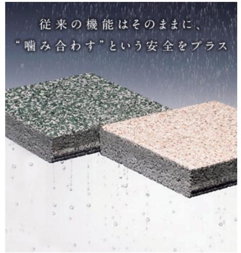
駅東口駅前広場に“不陸抑制型の舗装ブロック：TOYO ワンユニオンシステム”（国交省 NETIS 新技術情報システム申請）が採用されている。従来の舗装工事での車両乗り入れ部に発生しやすい、経年変化による強度低下・雨水による敷砂流出などによる不陸・段差の問題を改善するために開発された。横断面での凹凸の噛み合わせにより、地盤の不陸を表面に出ないようにしている。ただし逆に表面に出ない場合の問題点も有る。
